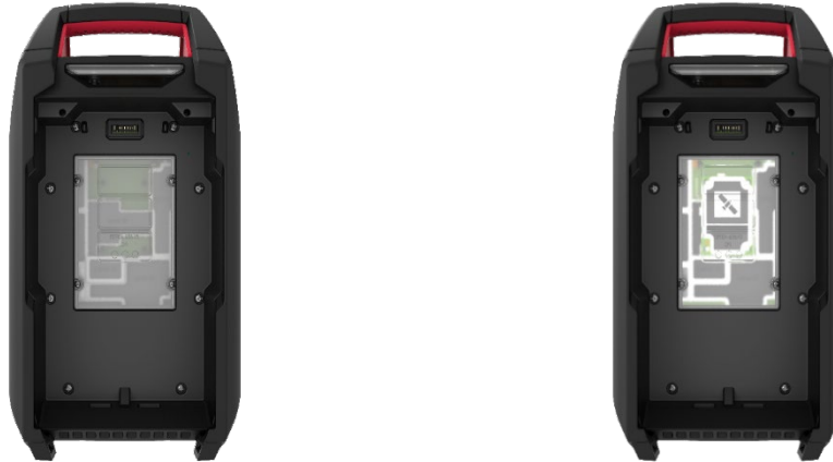
Figura 1-11: Conexión satelital no instalada 1-12: Conexión satelital instalada
